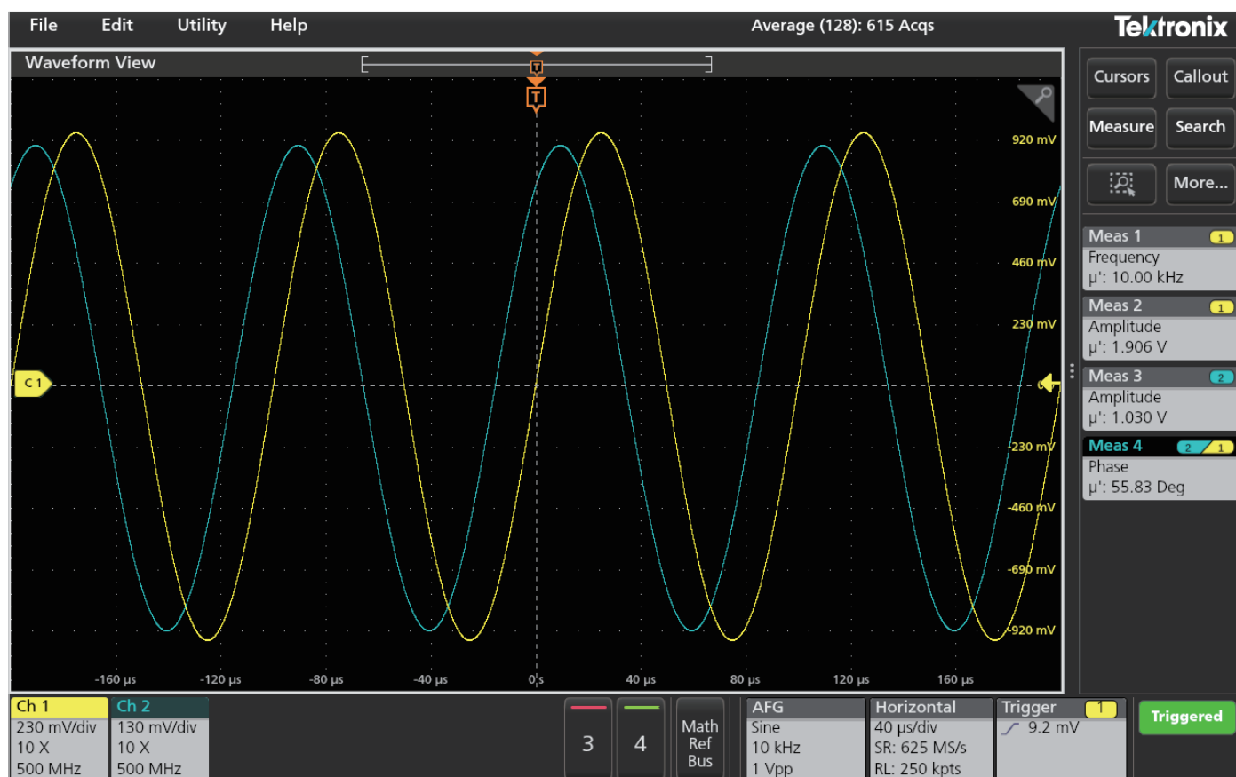
図6. A1とA2における電圧波形と測定値
